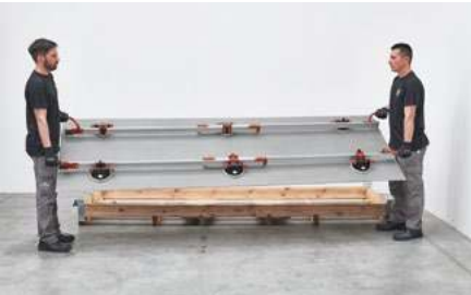
Pulire la superfice della lastra, all'interno della cassa o sul cavalletto prima di utilizzare il telaio per la movimentazione.
